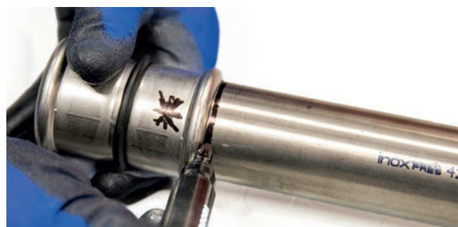
Fig. 32 – Markering av införingsdjupet med hjälp av en koppling
