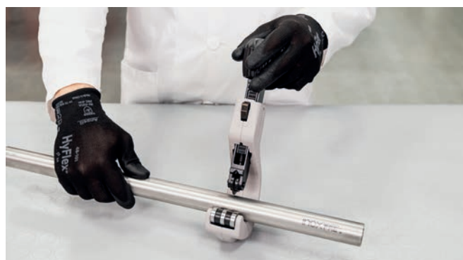
Fig. 26 – Kapning av röret till önskad längd
