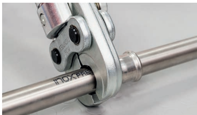
Fig. 37 – Utförande av pressanslutningen
